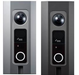
Панорамная камера с разрешением 2Мп позволяет получать чёткие кадры событий, происходящих перед входом, благодаря широкому углу обзора. Поддерживается одновременная видеосвязь высокой чёткости и двусторонняя аудиосвязь, что позволяет предоставить доказательства в случае противоправных действий, таких как вторжение, вандализм или другие преступления.
